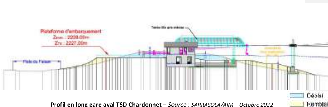
Profil en long gare aval TSD Chardonnet – Source : SARRASOLA/AIM – Octobre 2022
